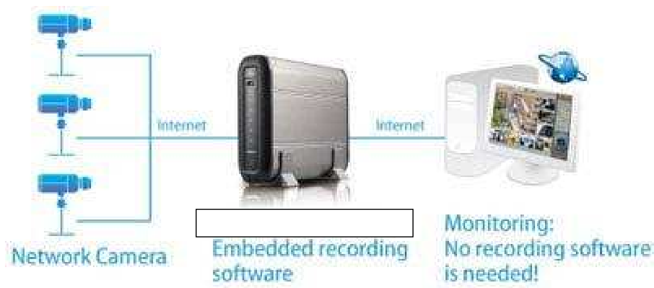
Rys.44 Schemat odbioru on-line obrazu z kamer monitorujących na komputerze, przez sieć internet
