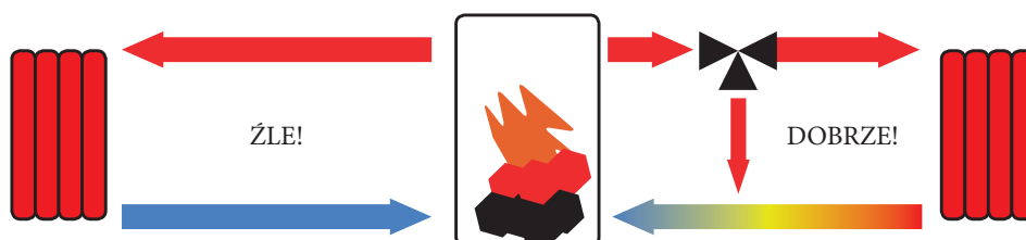
Rys. 34. Zastosowanie zaworu mieszającego
